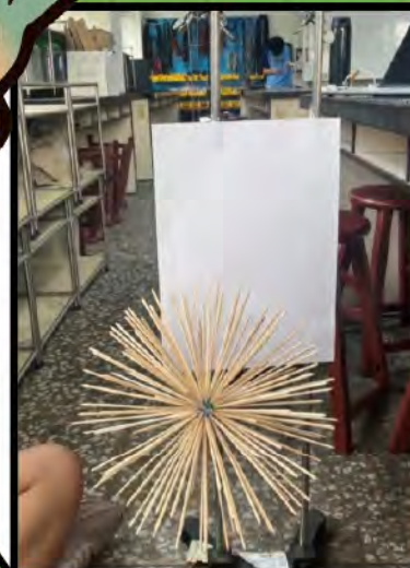
圖2 / 測量轉動慣量之實驗裝置
