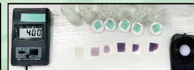
圖3 / 固定光源下檢測水楊酸標準品或是市售產品稀釋樣本
