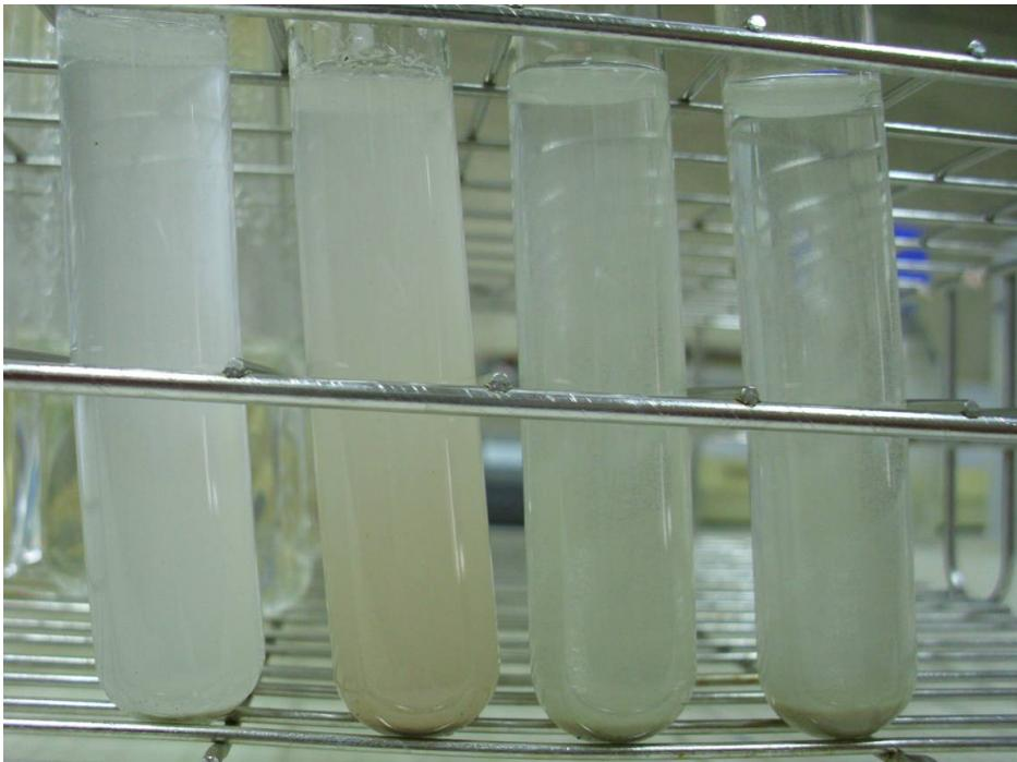
圖 39：不同煨燒時間的牡蠣殼粉末，取 0.1g 之粉末，加入 9.9g 之 RO water 後，其外觀之圖樣。從左至右分別為：未加熱、H<sub>600</sub>、H<sub>800</sub>、H<sub>1000</sub>。
