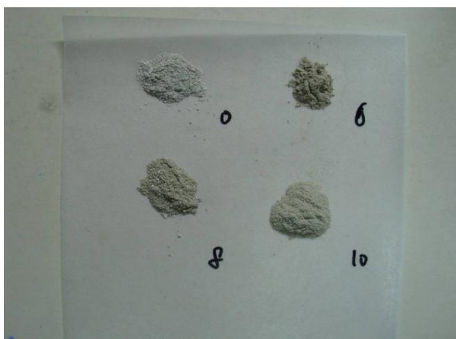
圖 9：不同煨燒溫度之下，經過磨碎、均質、過篩後的牡蠣殼粉末。圖中每一溫度的牡蠣殼粉末重量皆為 0.1g。
