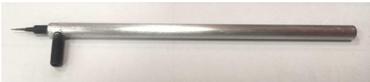
圖 25 粉刺針用止付螺絲固定時的外觀
