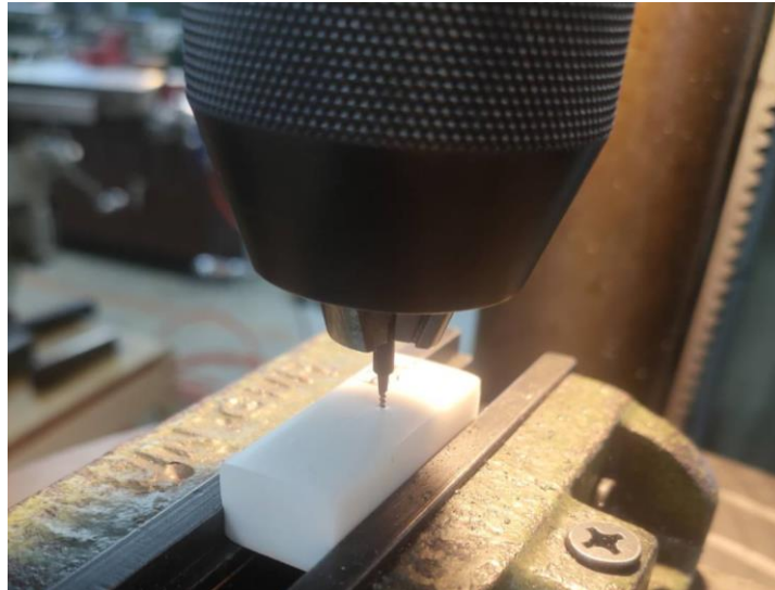
圖34 將粉刺針夾持於鑽床上進行穿刺測試
