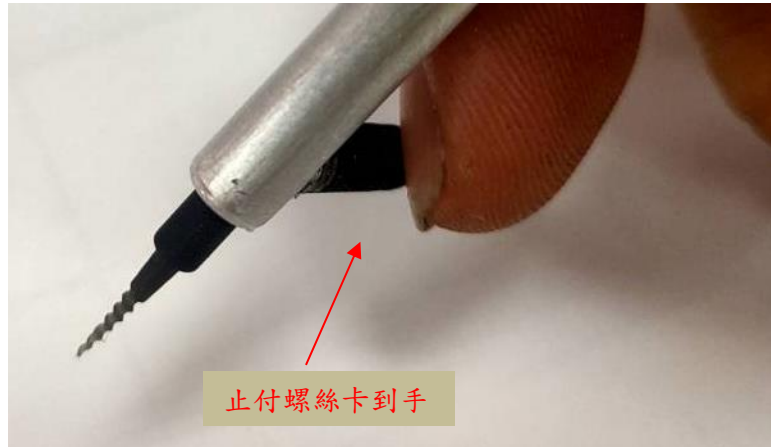
圖 24 操作時卡手的问题產生
