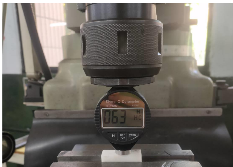
圖33 用銑床夾持硬度計測試橡皮擦的硬度
