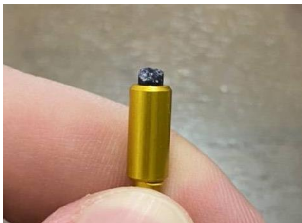
圖 28 十字立柱(凸)尺寸控制不易，斷在裡面也不好取出
