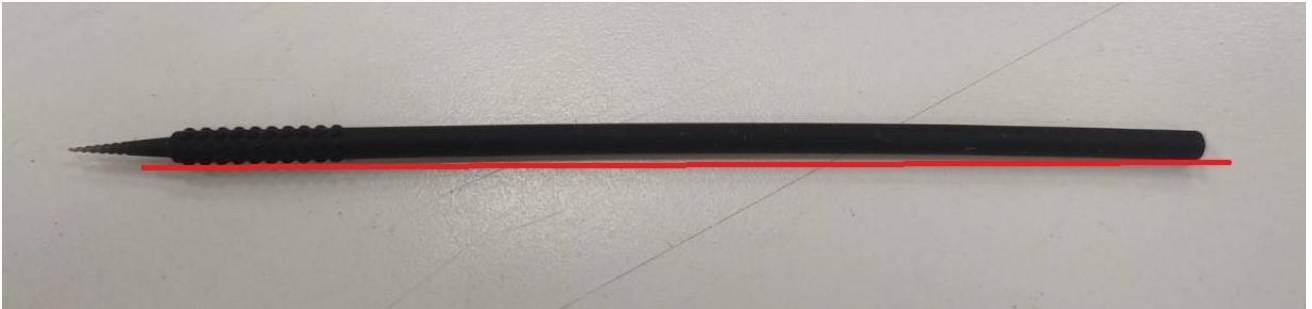
圖 17 由此紅線可以看出因列印後須進行二次固化時所產生的彎曲現象
