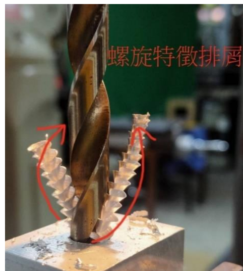
圖 15 鑽孔時切屑排出情形
