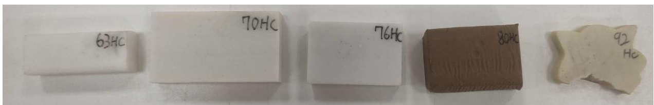
圖32 用邵氏硬度計測量橡皮擦的硬度值
