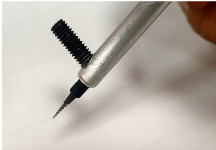
圖 23 原先粉刺針握柄前端的固定方式
