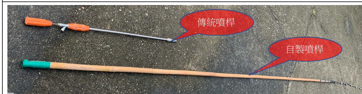
(圖 4-8-2)傳統噴桿 V.S 自製噴桿
