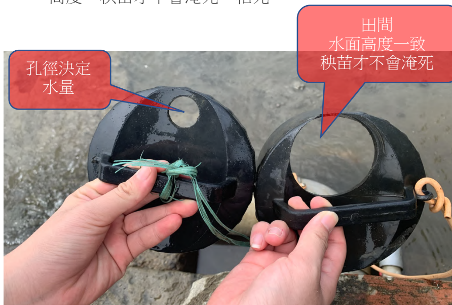
圖 4-4-8 進水管—塞子鑽孔(圖片來源：作者實驗現場拍攝)
