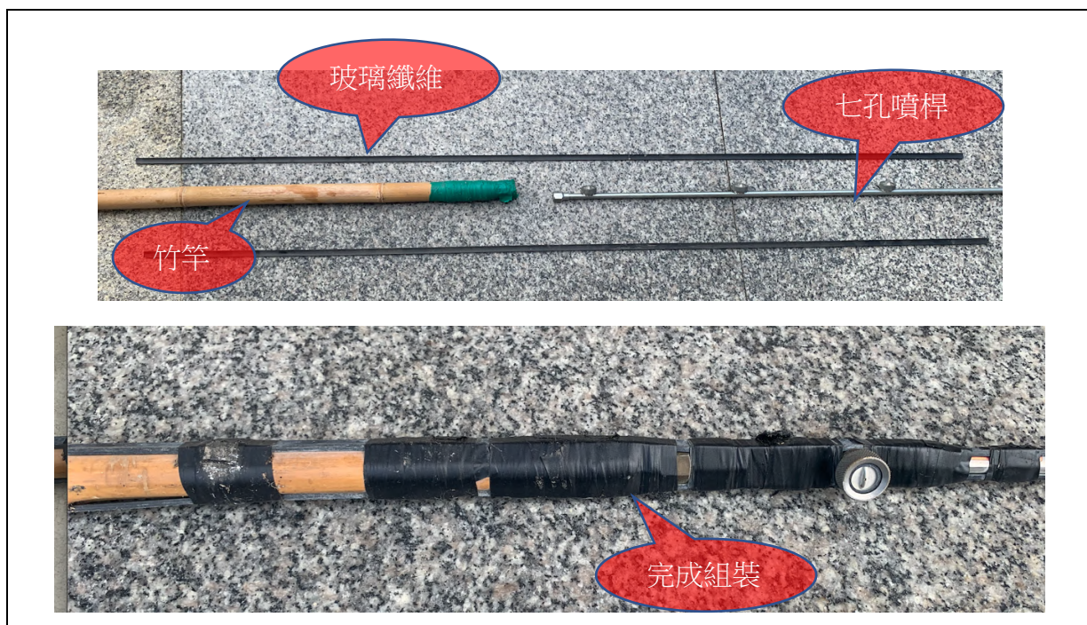
(圖 4-8-1)自製噴桿分解(上)、組裝(下)
