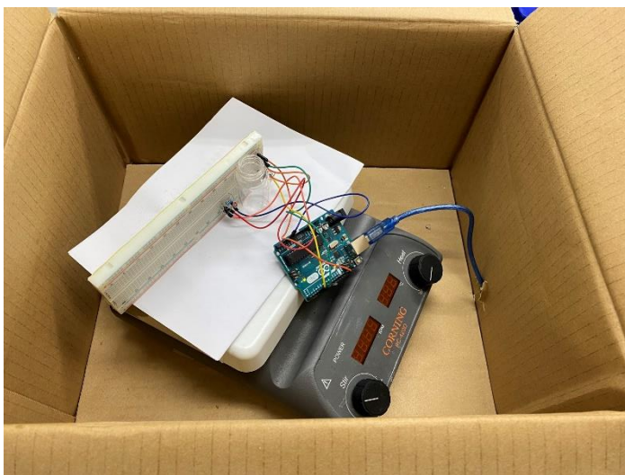
左圖為透光度檢測儀 使用時會關閉箱子遮光
