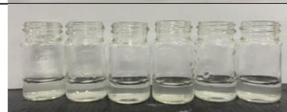
硫酸鈦檢測液 (pH2 緩衝液) 加入不同濃度魚浮靈 ( $H_2O_2 + Na_2CO_3$ )
