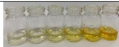
硫酸鈦檢測液加入不同濃度魚浮靈 ( $H_2O_2 + Na_2CO_3$ )
