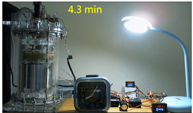
圖 29、第五版真空磁浮飛輪以 13.2 V 供電可持續 4.3 分鐘
