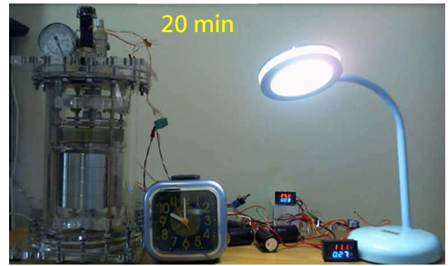
圖 28、第五版真空磁浮飛輪以 11.2 V 供電最多可持續 20 分鐘
