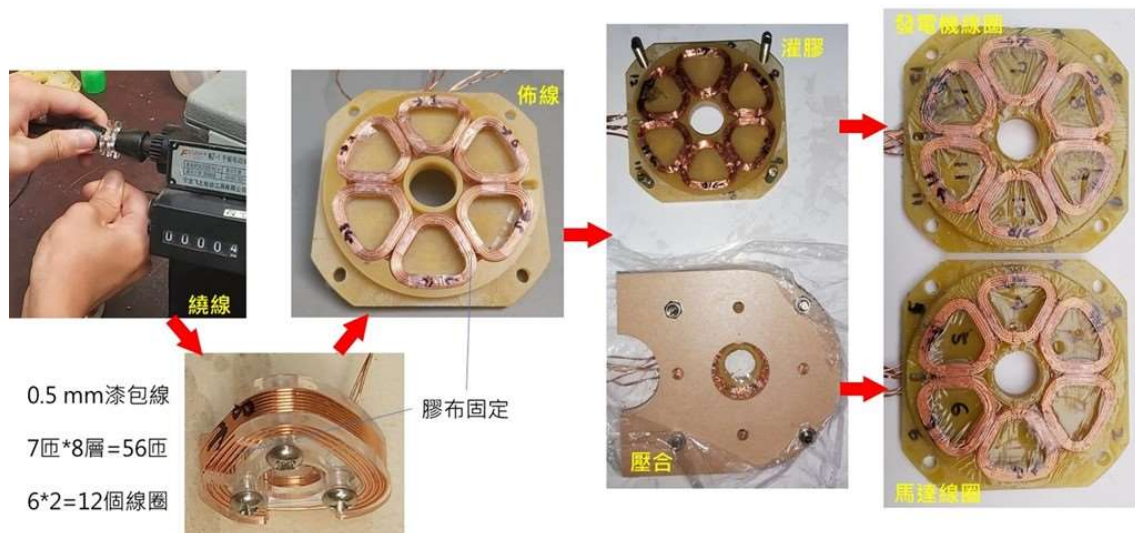
圖 16、馬達/發電機線圈製作流程(第一至三版飛輪)
