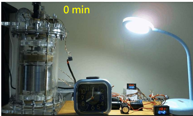
圖 29、第五版真空磁浮飛輪以 13.2 V 供電可持續 4.3 分鐘
