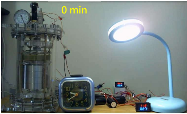
圖 28、第五版真空磁浮飛輪以 11.2 V 供電最多可持續 20 分鐘
