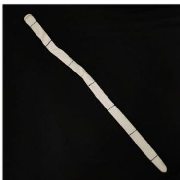
實驗中，我們可以從表格看到其實同一顆氣球，內部厚薄並不相同，越往吹口越薄，越往尾巴的部分越厚，我們推測可能與氣球的製作過程有關。
