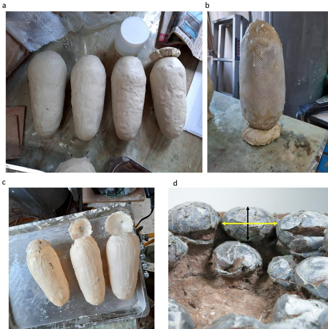
圖二：a. 竊蛋龍蛋形狀的油土。b. 刷上第一層樹脂與貼上玻璃纖維布的竊蛋龍蛋。c. 加熱脫去油土的竊蛋龍蛋。可以看到空心的蛋身以及留有孔洞給溫度計穿過的的蓋子。d. 蛋的最寬寬度與最厚厚度。黑色垂直軸為蛋的最厚厚度，黃色水平軸為蛋的最寬寬度。
