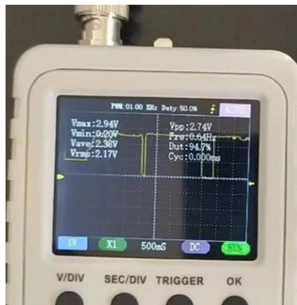
【圖 5-3-2】示波器測量到電擊瞬間所產生的電位波型
