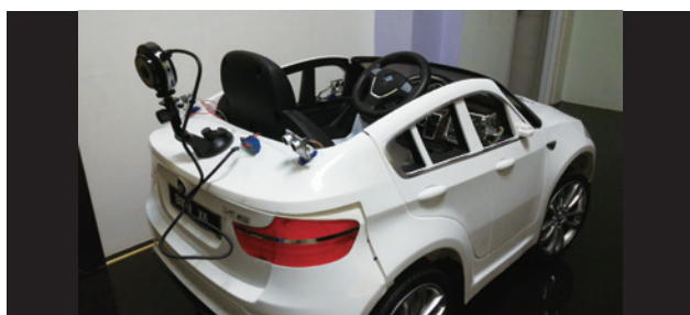
圖 2. 後方行車紀錄器安裝圖及駕駛側安裝開車門智慧防撞設計
