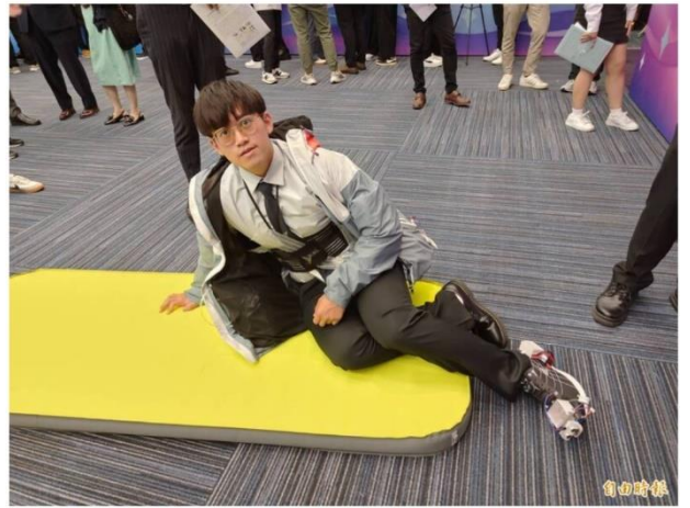
逢甲大學與中山大學團隊，開發「具步態診斷與防跌預測並連結防護裝置的新型智慧鞋設計」，可偵測跌倒姿勢併及實防護衣充氣，降低老人跌傷風險。（記者吳柏軒攝）
