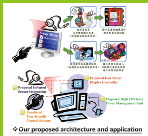
圖一 從系統、架構及電路三個層級來達到顯示裝置的節能省碳。
