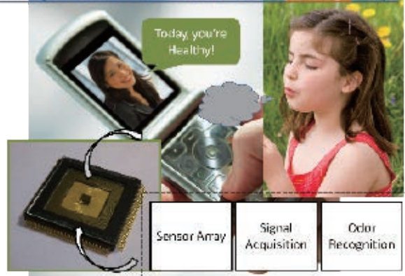
圖1 > 嗅覺晶片: 具備氣味辨識能力、小體積、低功耗、低製造成本、高電子相容性等特性，可作為個人健康照護裝置並承載於消費性電子產品（如手機）中
