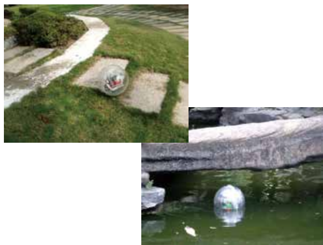
圖2 (左上) > 球型機器人能在路面行走，也可在草地行走以及下階梯 圖3 (右下) > 球型機器人具防水功能，可在水中進行偵查
