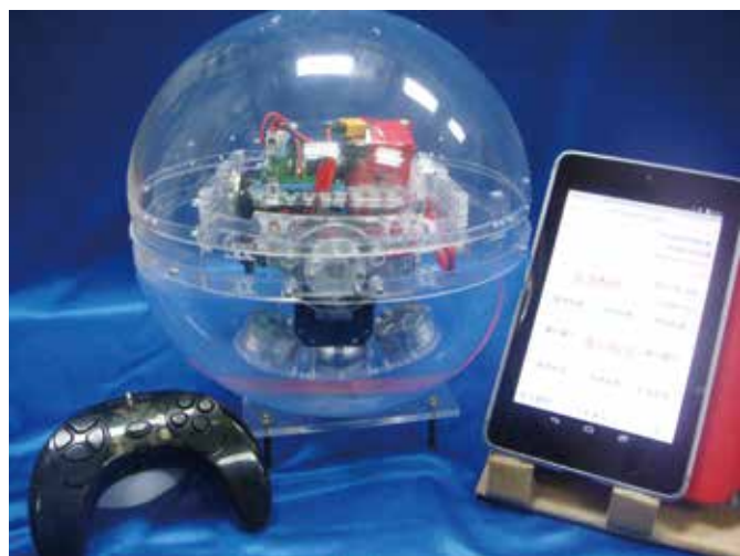
圖1 > 球型機器人可透過平板電腦及搖桿控制
