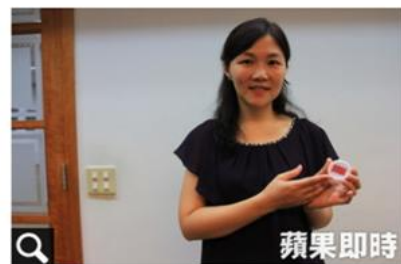
這塊超靈敏氣體感測晶片，可偵測魚肉與細菌反應時揮發的超微量(ppb等級)胺類氣體。黃羿馨攝，
