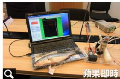
交大利用生鮮類菌敗時，會與細菌產生胺類氣體原理，再透過感測晶片來檢測水產鮮度。黃羿馨攝
