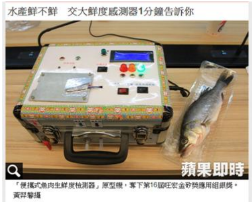
交大利用生鮮類菌敗時，會與細菌產生胺類氣體原理，再透過感測晶片來檢測水產鮮度。黃羿馨攝
