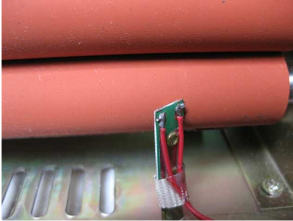
圖 34.溫度探頭傾斜45%
