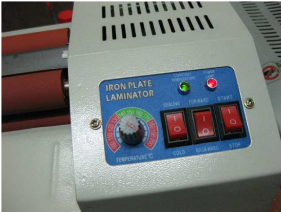
圖 42.溫度到達指示燈亮起 機器溫度到達。將板材由後方置入，後方膠輥是沒有加熱的，會先使紙張平整，而後進行轉印。
