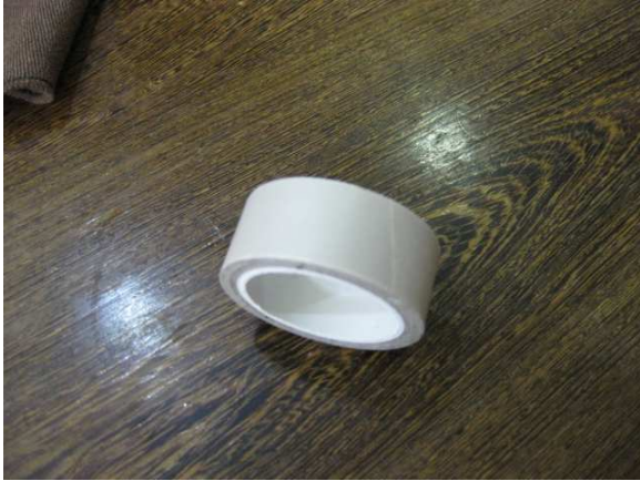
圖 40.耐高溫膠布 使用耐高溫膠布，將離型紙固定。
