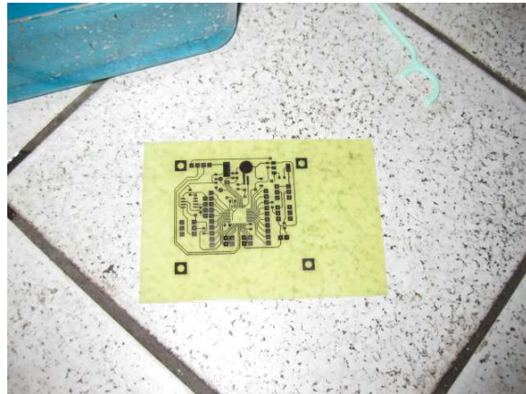
圖 49.腐蝕完成的電路板
