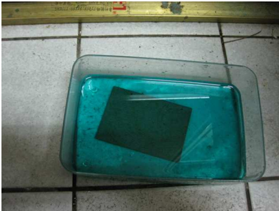
圖 38.丟入腐蝕液中
