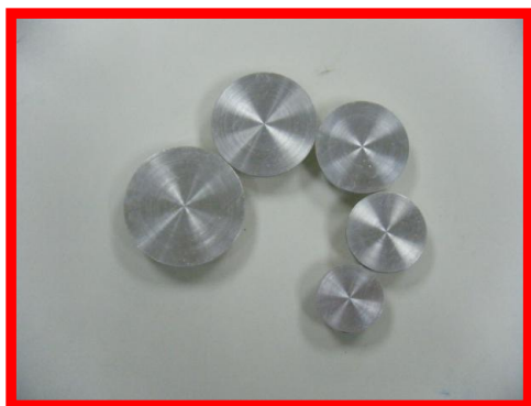
衝擊板 (實驗中使用直徑 2.5、3.0、3.5 cm 規格)
