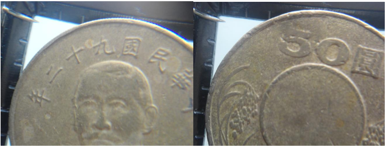
左圖硬幣中，國父幾乎沒有頭髮（偽幣），右圖硬幣中心『五十』字樣非常模糊（偽幣）
