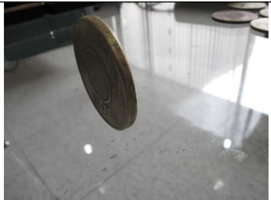
側邊壓花方面深淺不一，有時淺有時深，表示材料滾邊沒有調和好
