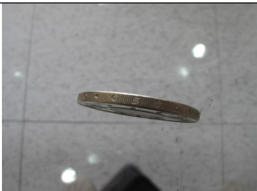
壓花方面的英文字母有凸痕，表示製造偽幣之廠商不懂得如何控制力道
