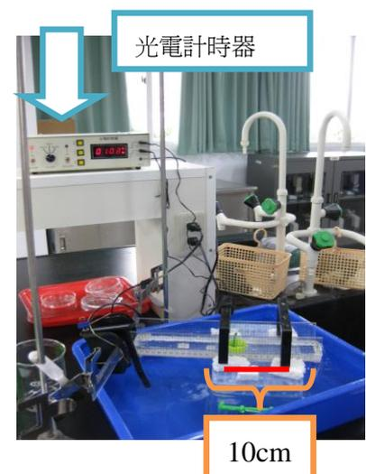
圖十一、馬達流速測定裝置示意圖
