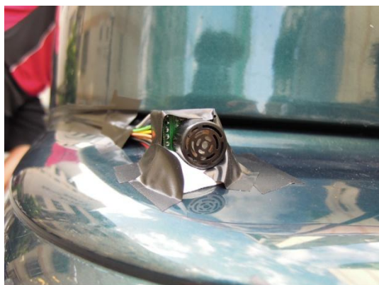
圖 13 超音波感測器於後保險桿安裝圖
