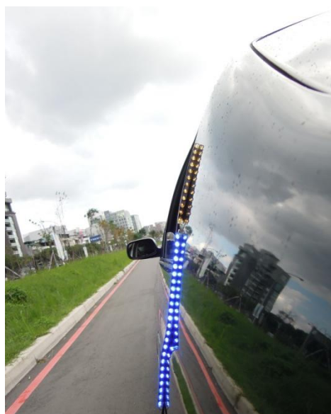
圖 14 LED 燈條於後車門縫後方安裝
