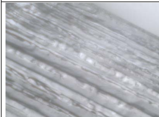
圖十九：偏光顯微鏡觀察左瓶(室溫搖晃溶液)瓶口的氯化鈉結晶，發現毛細管的層狀結晶內有溶液流動，顯然攀晶現象是動態，結合「微米尺度的毛細現象」與「奈米顆粒的表面現象」。
