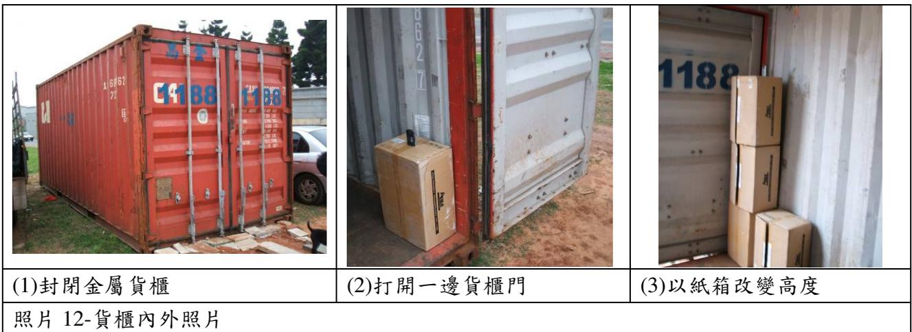
貨櫃完全封閉的狀態下，收音機是完全沒有訊號，於是我們開啓一邊的門，以紙箱做為放置收音機的底座，並固定天線的方向朝上，試圖量測貨櫃空間中不同位置的收音狀態，並改變高度量測出三種高度的實驗數據。我們把貨櫃空間做等大小的切割，並以把收訊品質區分成三種類型，x 為沒有收訊，v 為有雜訊，o 為收訊良好，並對同一層高度進度整理。圖 11 的紅色區域為貨櫃的開口處。
