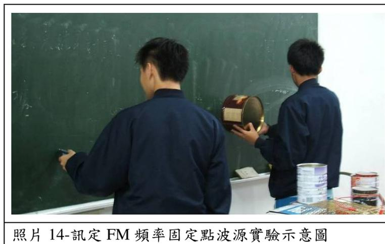
我們分別對白板、小黑板與大黑板做實驗，發現若發射器的波源在金屬板中央，不論我們設定的廣播電台頻道為何(只要不被蓋台)，實驗結果完全符合模擬，如圖 16，也可以確定，我們先前的實驗模擬設定以電磁波波長 330 公分，大致上可以普遍適用於各種不同電台。
