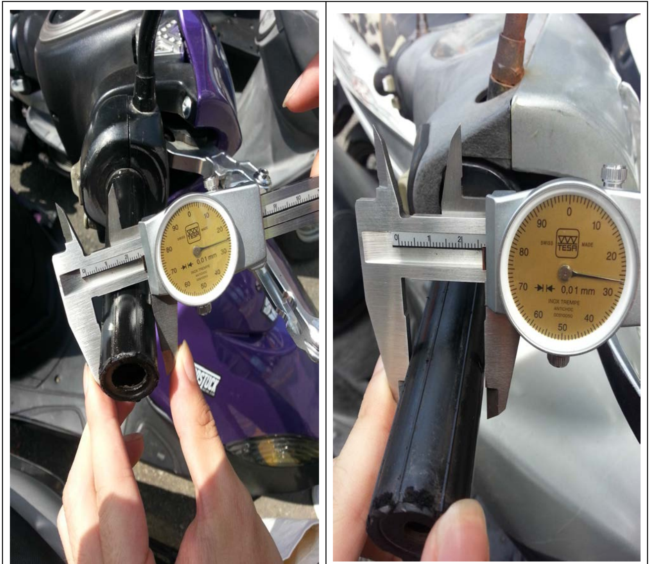
YAMAHA 廠牌的機車，我所測量出來的尺寸是 2.625 公分 (26.25mm)
