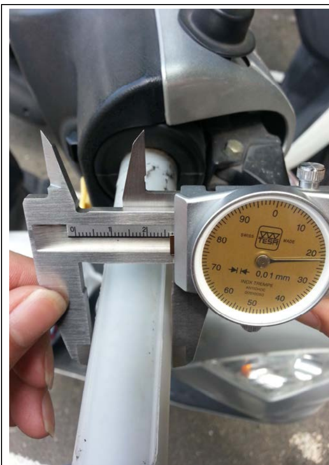
KYMCO 廠牌的機車，我所測量出來的尺寸是 2.622 公分 (26.22mm)
