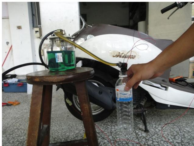
圖十五：測量怠速油耗情形示意圖
