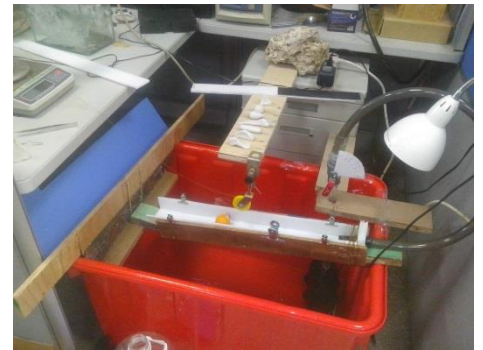
圖四 自製可變流速水道組 Ver.3.0
