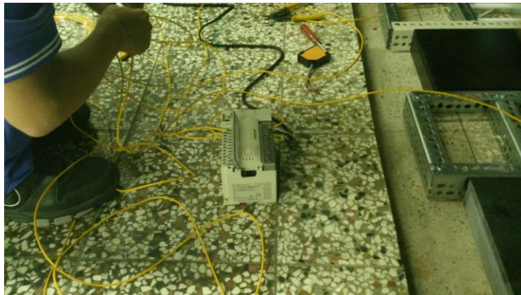
圖 9 LED 燈座結合 PLC
