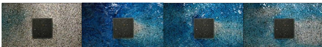
圖 3-3-2 水流流經壓克力正方柱的變化
