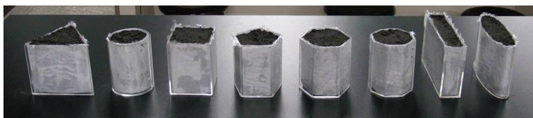
圖 2-3-3 已裝沙子的障礙物擬橋墩模型
