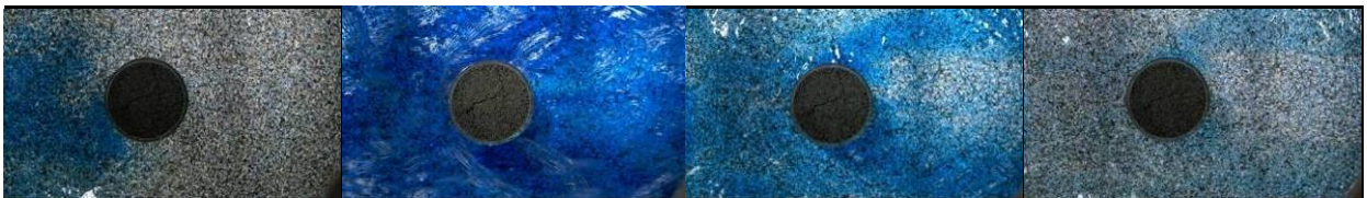
圖 3-3-7 水流流經壓克力圓柱的變化
