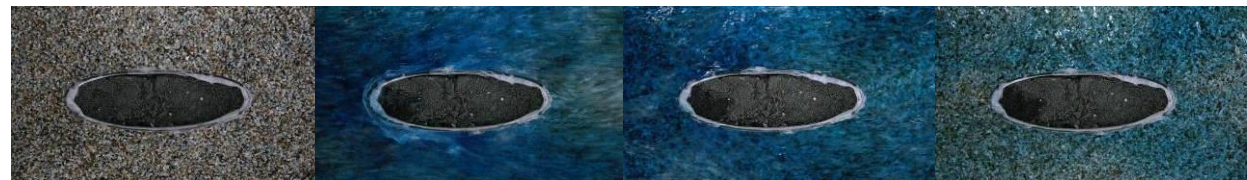
圖 3-3-8 水流流經壓克力橢圓柱的變化
