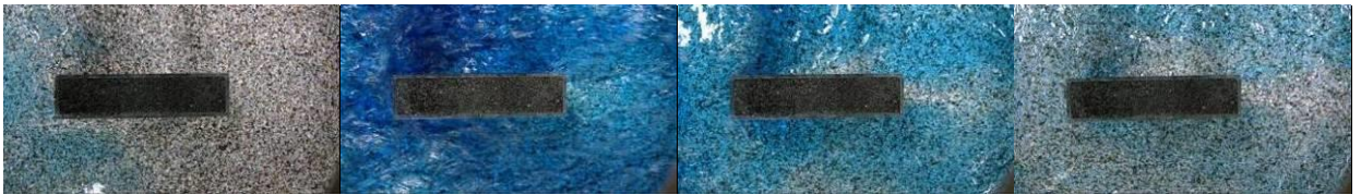
圖 3-3-6 水流流經壓克力長方柱的變化
