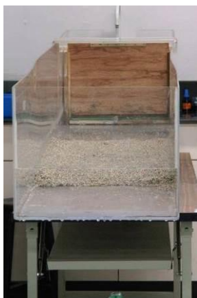
圖 2-3-1 壓克力仿河道模型
