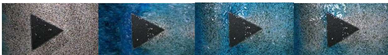
圖 3-3-1 水流流經壓克力正三角柱的變化
