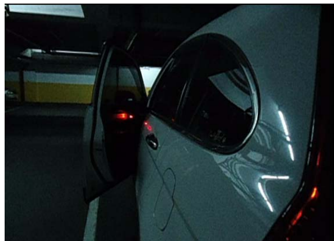
圖 70 實際裝置於汽車時警示燈閃爍情況
