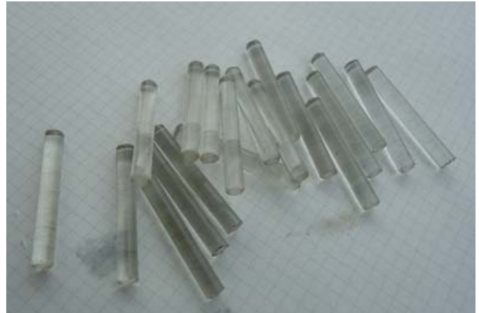
圖 32 以壓克力材質製作安全銷
