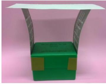
如左圖紙片模型，上方平面代表鋁片，底兩側彎曲的紙片代表水滴的曲面。鋁片上移過程，紙片可以輕易地往中間縮回(假設完全無障礙力)；但是鋁片在下移過程，紙片向外擴張受到不穩定的障礙力，也就是紙片常常「卡住」。因此這個模型可以解釋鋁片上拉時水滴 F-t 圖是平滑的，而鋁片下移過程，水滴向外擴張過程是不順遂的，以致 F-t 圖產生階段性變化的現象，同時需要較多的時間才能趨於穩定。
