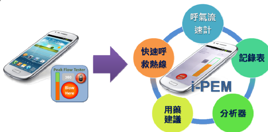
圖 20 將智慧型手機與 App 結合成多功能尖峰呼氣流速計
