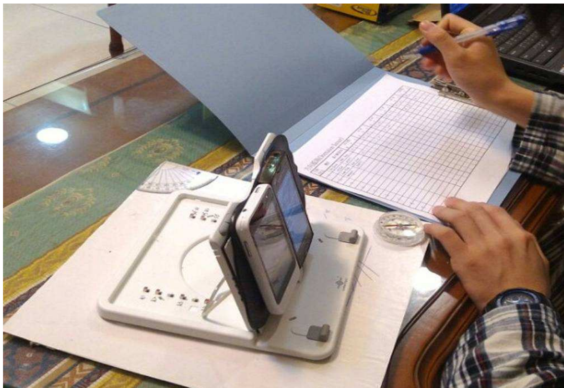
圖:使用閱讀架改裝的角度測量工具，測驗各家手機的角度的準確性。
