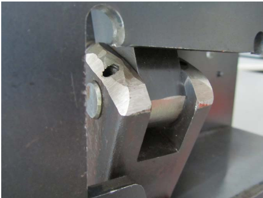
圖 46 經過熱處理後及使用後的痕跡
