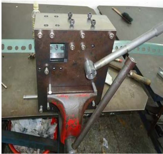
圖 40 角鋼裁切裝置組裝完成圖
