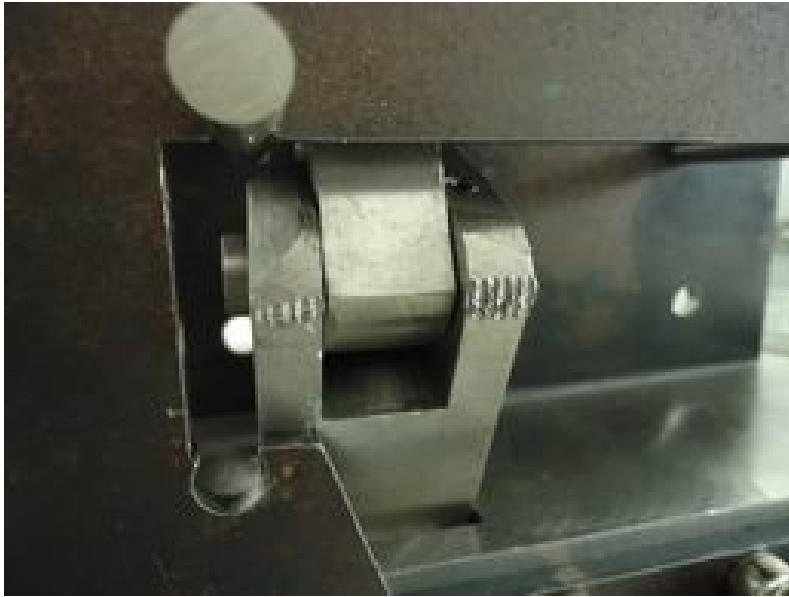
圖 45 肘節機構連桿受損
