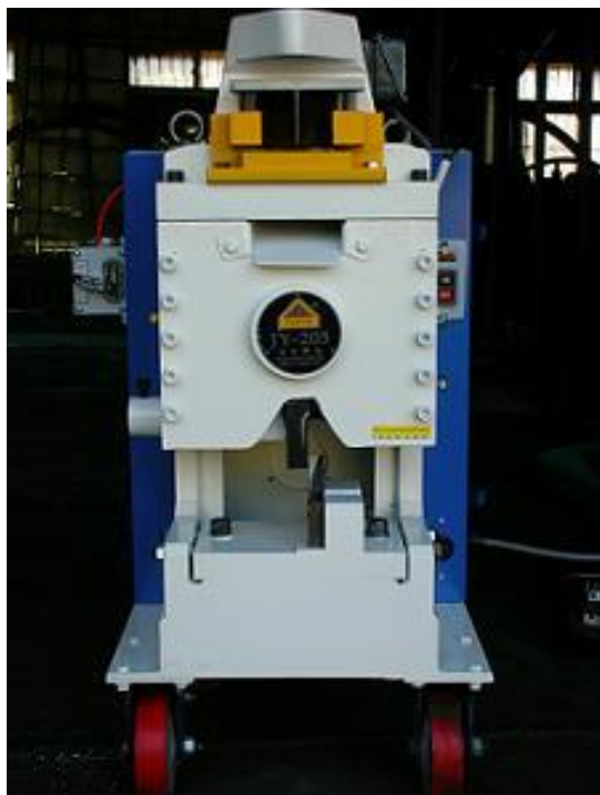
圖 3 大型角鋼裁切機台
