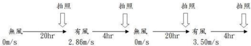
圖 9、溝槽角度與風之關係實驗流程示意圖
