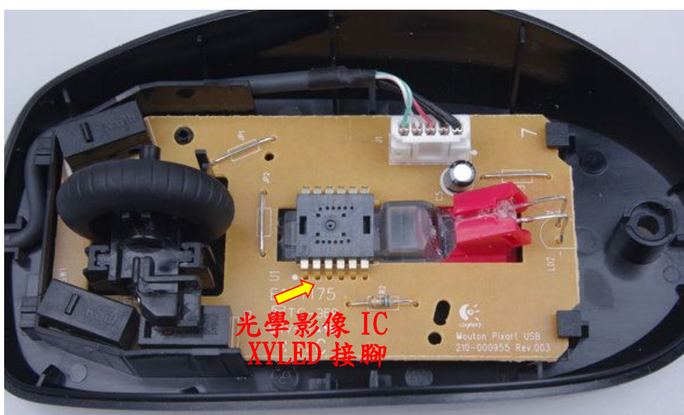
圖9-3、光學滑鼠內光學影相感測IC實體圖
