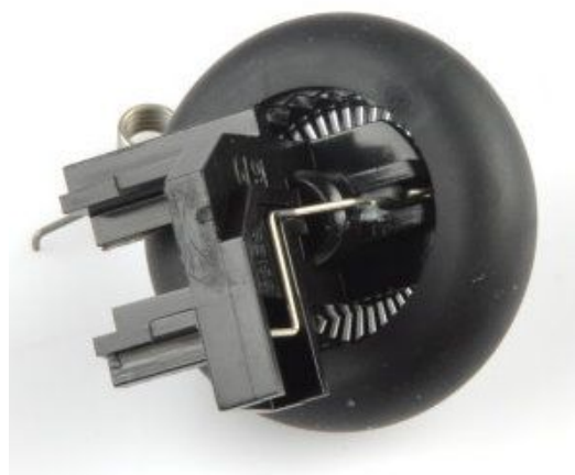
圖 4-6(b)、滑鼠滾輪光學式編碼器連接架構圖
