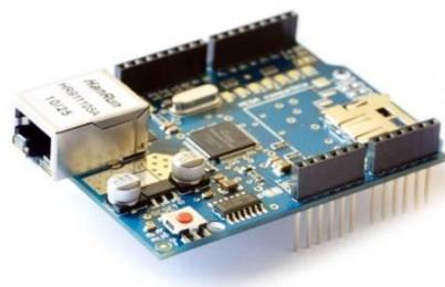
圖 9 Arduino W5100
