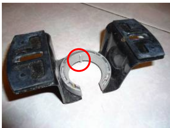
圖 66 吊扇固定座上的圓球槽 (注意上方有一凸塊)
