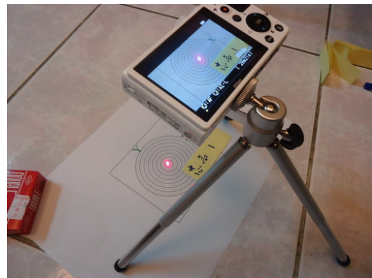
圖 50 以 P310 相機錄影雷射光點
