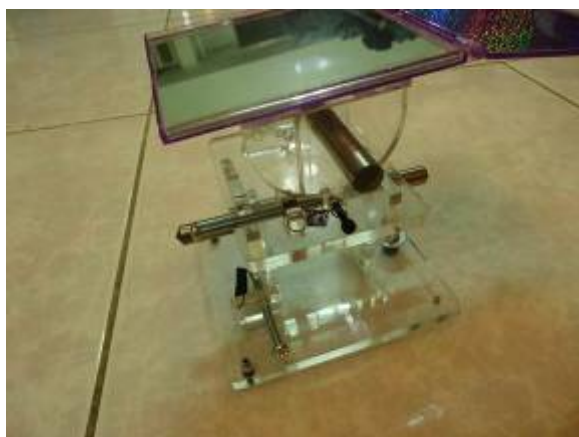
圖 24 反射鏡萬向調整設計
