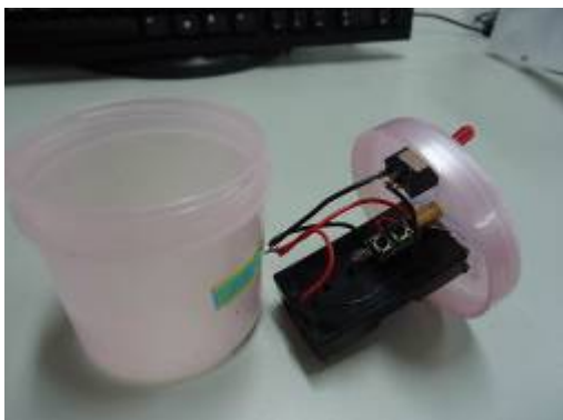
圖 17 初步製作的雷射筆固定盒
