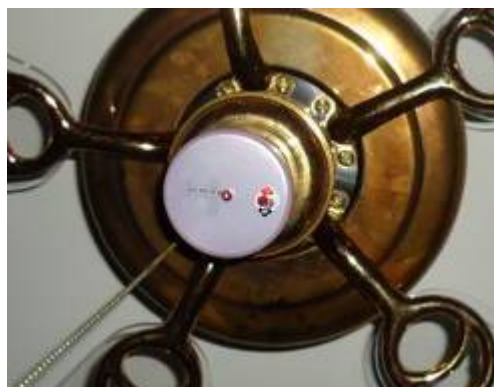
圖 18 雷射筆固定盒吸附在吊扇下方
