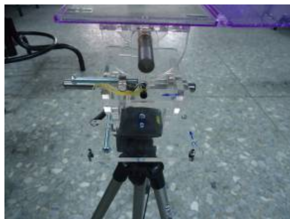
圖 25 萬向反射鏡安裝於相機腳架上
