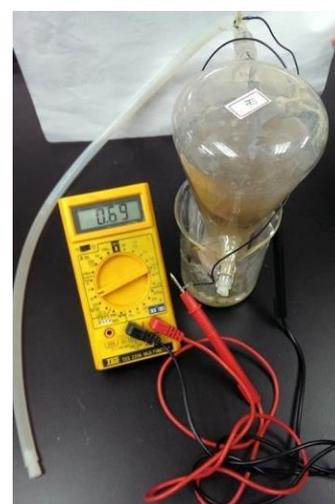
(四) 查閱微生物電池相關論文，多數微生物電池使用質子交換膜分隔陰、陽極，然質子交換膜成本相當高，故本裝置發展為無膜式 (membrane-less) 微生物燃料電池，使用溶有電解質的固態洋菜分隔陰、陽極，不僅材料便宜、易取得，且防止空氣滲透的效果極佳。
