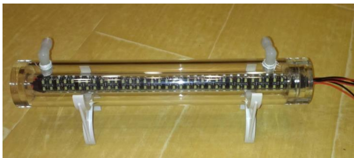
圖 3-1 自製簡易光觸媒循環式淨水裝置
