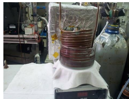
圖 3-2 冰水機+磁石攪拌器
