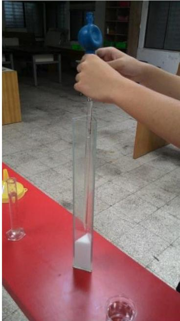
圖(10) 分度吸量管沿管壁注入純水
