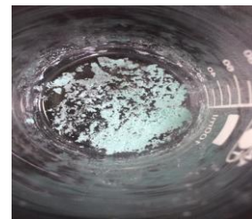
圖 11 銅分子模板經由晾乾後，再經由研磨及篩選過程即可得到對特定重金屬具有高度專一性之分子模板。
