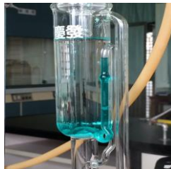
圖 10 將銅分子模板利用索氏萃取器進行重金屬移除及萃取，以形成具有專一性之孔洞。
