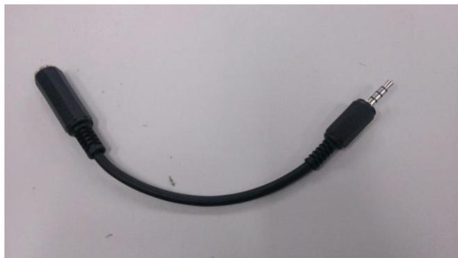
圖 22 自製轉接頭在內部已經互換麥克風的正負接點
