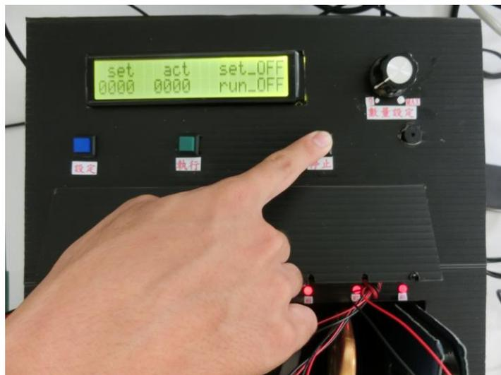
圖 43 按下紅色的停止鈕後 LCD 顯示狀態
