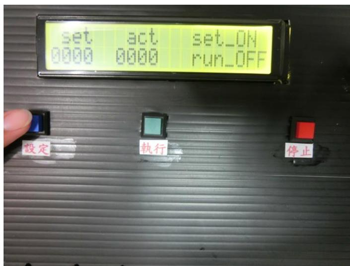
圖 37 按下藍色設定按鈕後 LCD 顯示狀態
