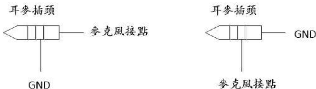
圖 21 4 極性的耳麥插頭在麥克風上有兩種不同接點方式
