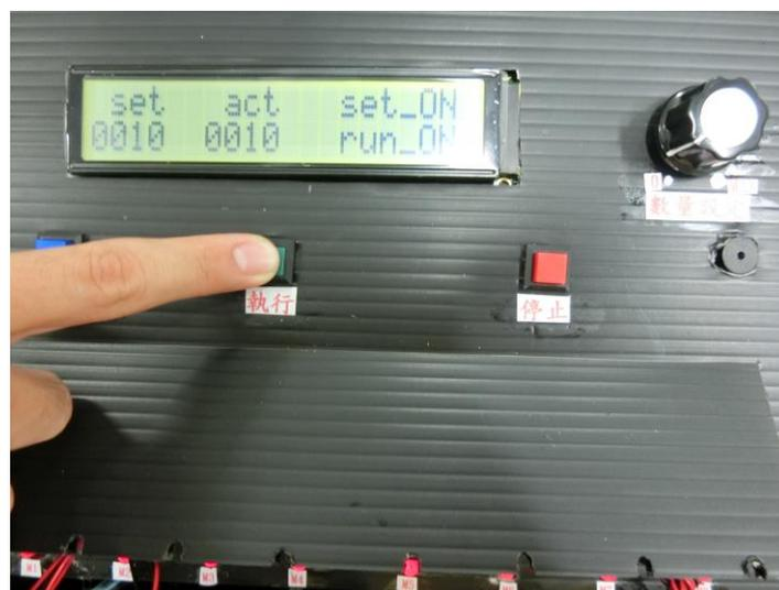
圖 39 按下綠色的執行鈕後 LCD 顯示狀態
