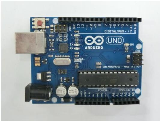
圖 5 Arduino UNO 板
