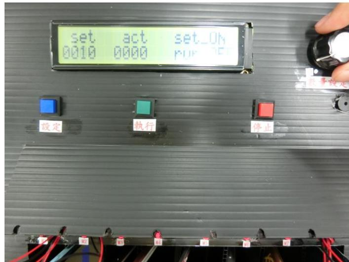
圖 38 轉動右上角旋鈕即可設定手機需求數量
