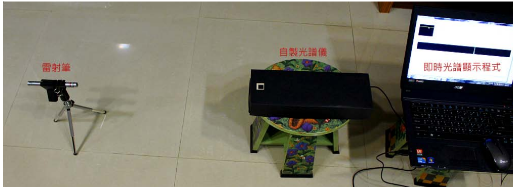
圖 15-1 自製光譜儀的準確度測試裝置圖
