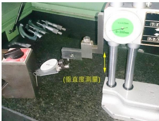
圖 15 垂直度測量實況
