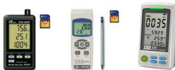
圖 4 氣溫溼度氣壓儀、風速計及空氣品質監測計
