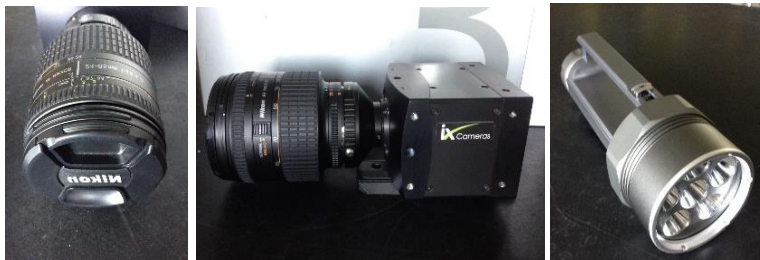
圖 3-5 a. Nikon 鏡頭 (zoom 24~85mm) b. 高速攝影機主機 (912fps~1005fps) c. 高速攝影機專用強光手電筒(不會閃爍)
