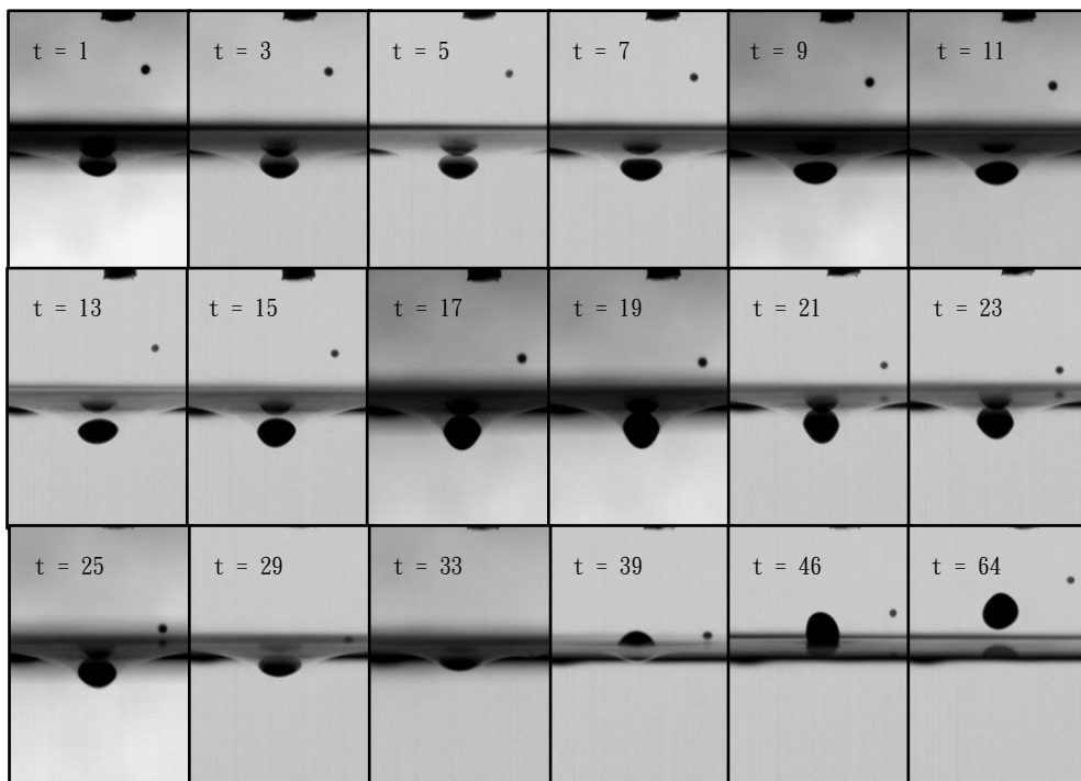
圖 4-1 皂水小球彈跳過程 ( t = 1/1005 \text{ s} )：母球彈跳，子球亦彈跳。
