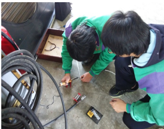
圖 7 用電烙鐵焊接三條 LED 燈條
