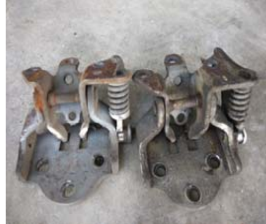
圖 16 取下傳統車門樞接裝置 (一代)
