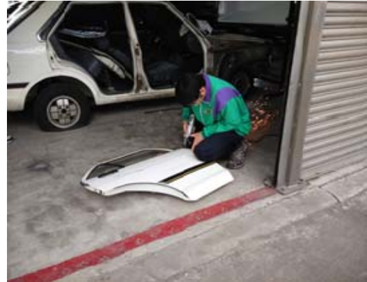
圖 18 用砂輪機鋸掉車門小部分
