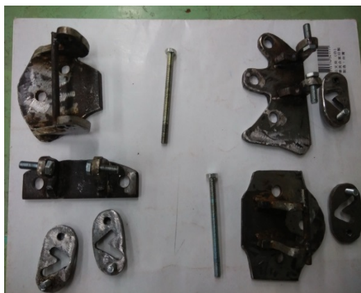
圖 21 車門樞接裝置（三代）之分解圖
