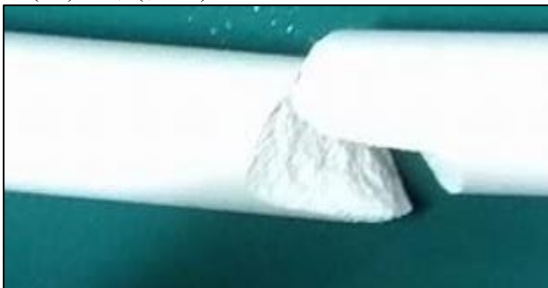
(圖三十七)實心粉筆經扭轉後斷裂圖
