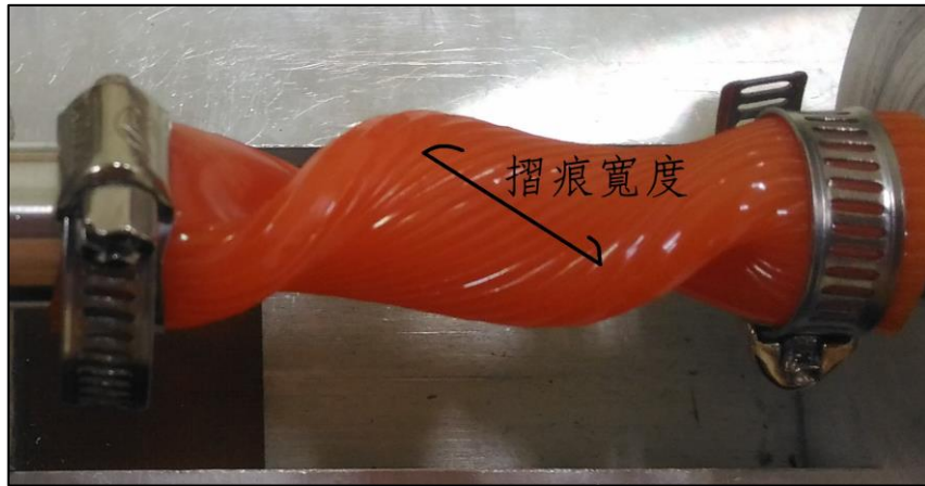
(圖三十六)水管( R/w=0.30 )扭轉示意圖
