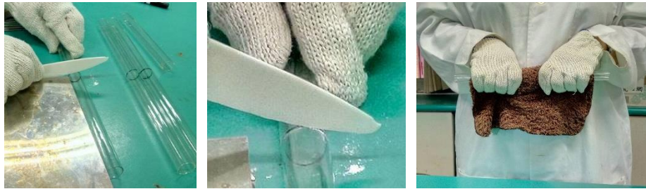
圖(10): 將 30cm 玻璃管切成兩半的方法，先用陶瓷刀切鋸，再小心折斷。
