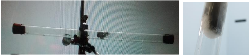
圖(8)：模擬在火場通道堆積物體的燃燒黑煙
