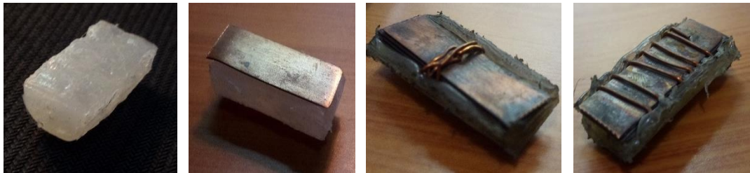
圖(11): 半通道障礙物：由左到右分別為(1)熱熔膠、(2)熱熔膠貼銅片、(3)熱熔膠貼銅片及繞銅線、(4)熱熔膠貼四層銅片及繞多圈銅線使表面凹凸不平。
