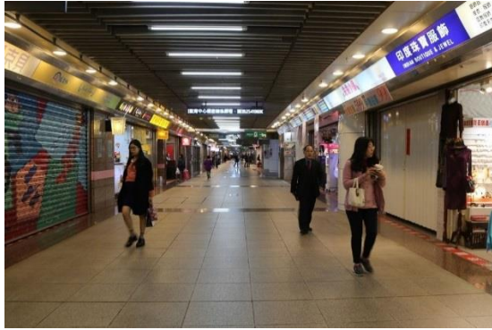
圖(18):台北車站地下街，空曠的地下街加上導熱的商店鐵門是很容易讓火與黑煙快速四竄
