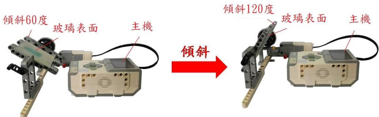
圖六、表面測試裝置傾斜示意圖
